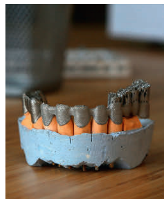
Каркас для мостовидного протеза, материал ПР-КХ28М6 (аналог MP1)
